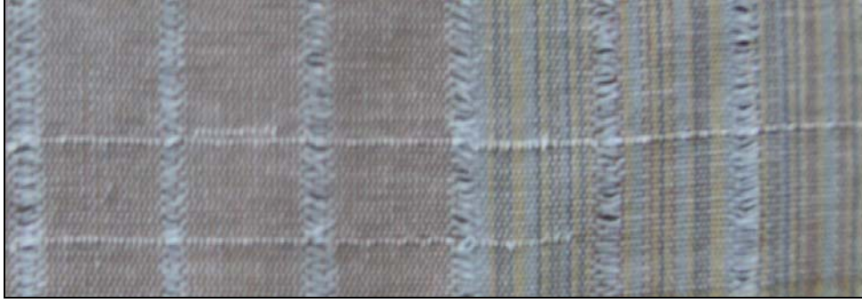
Şekil 16. Kalın atkı (Kumaşta normalden fazla atkı telinin bulunması)
