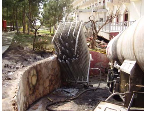
Şekil 7,8. Tır tankının yanmış durumu ve seyyar yapılan buharlaştırıcı
