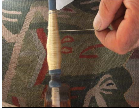
Şekil 12. Hatalı sarılmış masur
