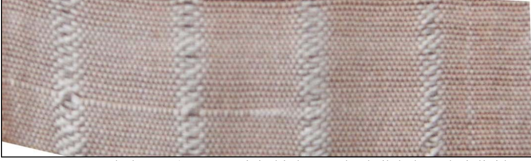
Şekil 18. Yarım atkı kaçığı (Kumaş eninin bir kısmında eksik kalan atkı ipliği hatası)
