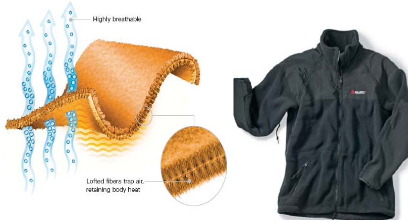
Şekil 2. Soğuk iklim tekstil materyallerinin katmanlı yapısı ;Dışta su geçirmeyen yapı,ortakısımda nefes alabilen membran bir yapı,iç kısımda da ince örme bir astar bulunmaktadır. (www.polartec.com)
