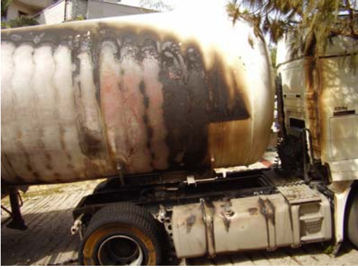
Şekil 7,8. Tır tankının yanmış durumu ve seyyar yapılan buharlaştırıcı
