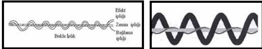
Şekil 1. Bukle ipliğin yapısı [5, 8]
