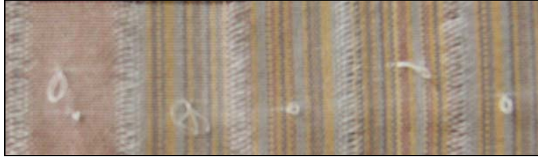
Şekil 15. Kumaş yüzeyinde atkı çıkığı
