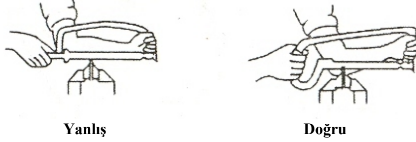
Şekil 2. Testere kullanımı için tutuş pozisyonu (Dul, 2007'den değiştirilerek)
