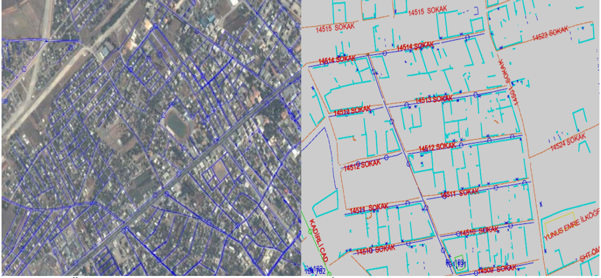
Şekil-3: Ölçülen Altyapı Tesislerinin Osmaniye İli Uydu Fotoğrafı ve Hâlihazır Haritası Üzerine İşlenmesi.
